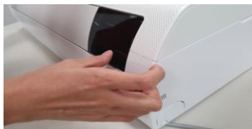
ไม่มีจุดยึดสกรู ถอด cover panel ด้วยมือ
