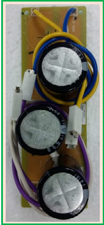
แผงคาปาซิเตอร์
